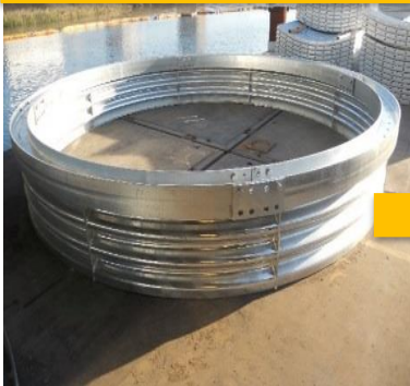
ライナープレート仮組・検査
