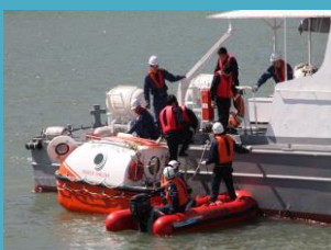
津波避難シェルター
